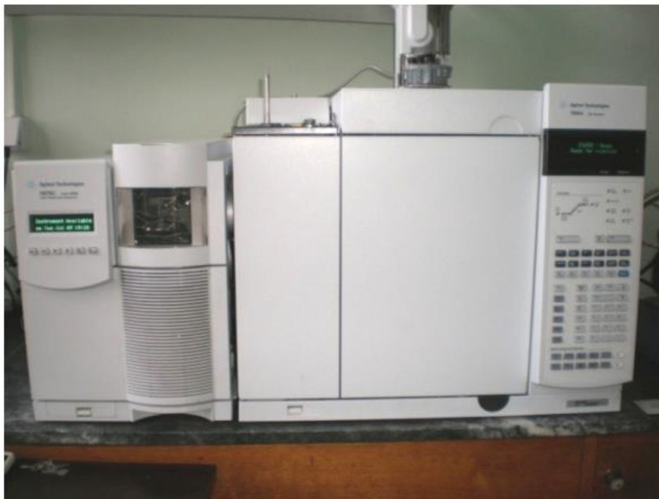
Слика 63. Гасни хроматограф Agilent 7890A са масеним детектором Agilent 5975C .
