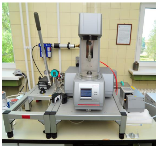
Слика 59. Модуларни компактни реометар Anton Paar MCR 302 (a); CC-27 вретено-цилиндар мерни систем (б).
