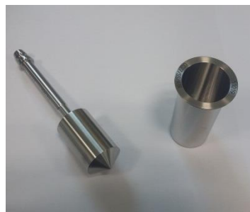
Слика 59. Модуларни компактни реометар Anton Paar MCR 302 (a); CC-27 вретено-цилиндар мерни систем (б).
