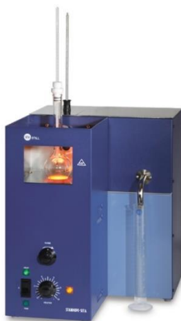
Слика 60. Апарат за атмосферску дестилацију Stanhope-Seta Setastill Distillation – 11860-3 .
