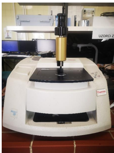
Слика 62. Thermo Fisher Scientific Nicolet 380 FTIR спектрометар са DTGS детектором и Smart Orbit Diamond ATR ћелијом.
