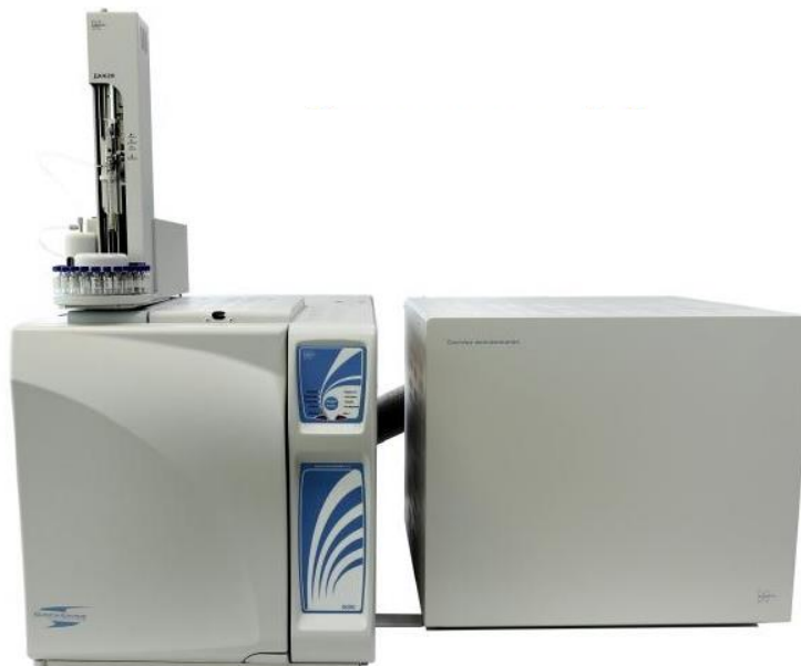
Слика 61. Гасни хроматограф Хроматек Кристалл 9000 са уграђеним пламенојонизујућим детектором и системом за хлађење.
