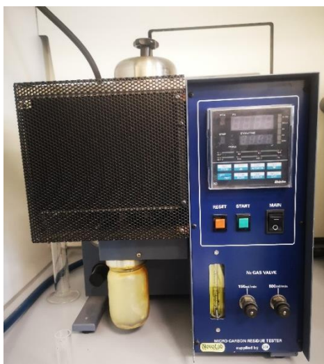
Слика 58. Апарат Stanhope-Seta Micro Carbon Residue Tester 97400-2 за одређивање угљеничног остатка микрометодом.
