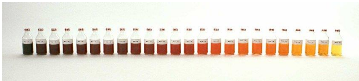
Слика 1. Варијације боја у којима се може јавити нафта (Dubost et al. , 2007).
