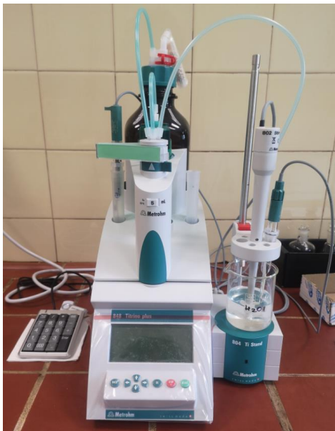
Слика 57. Аутоматски потенциометријски титратор Metrohm 848 Titrino plus .
