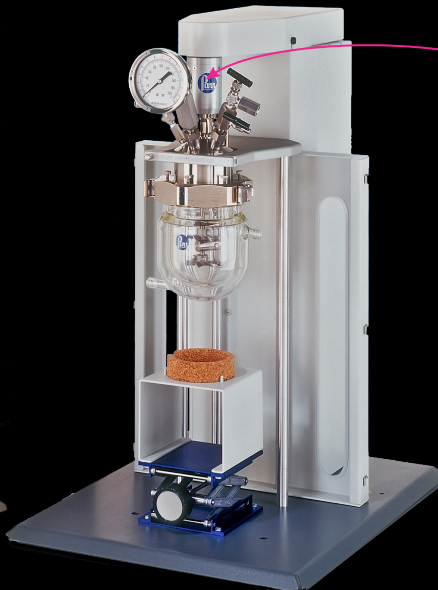
B. STAKLENI AUTOKLAV, SKLOPLJEN (DO ~ 20 atm, >100°C)
