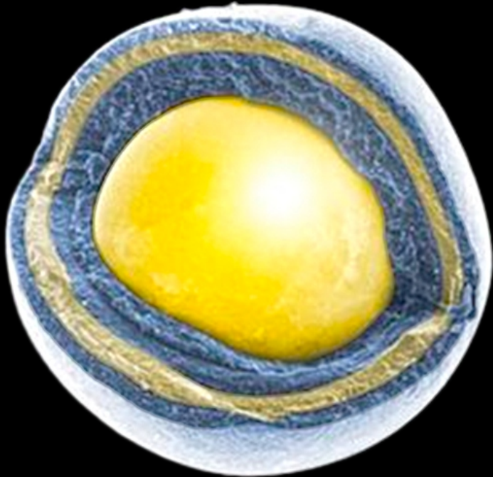
TRISO GORIVNO ZRNO, 0.93 mm. (DIGITALNO OBOJENA FOTOGRAFIJA)
