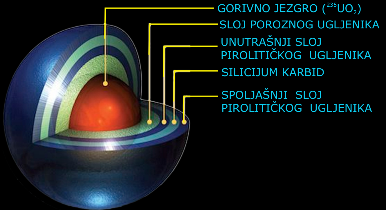
TRISO GORIVNO ZRNO, SHEMATSKI PRIKAZ.
