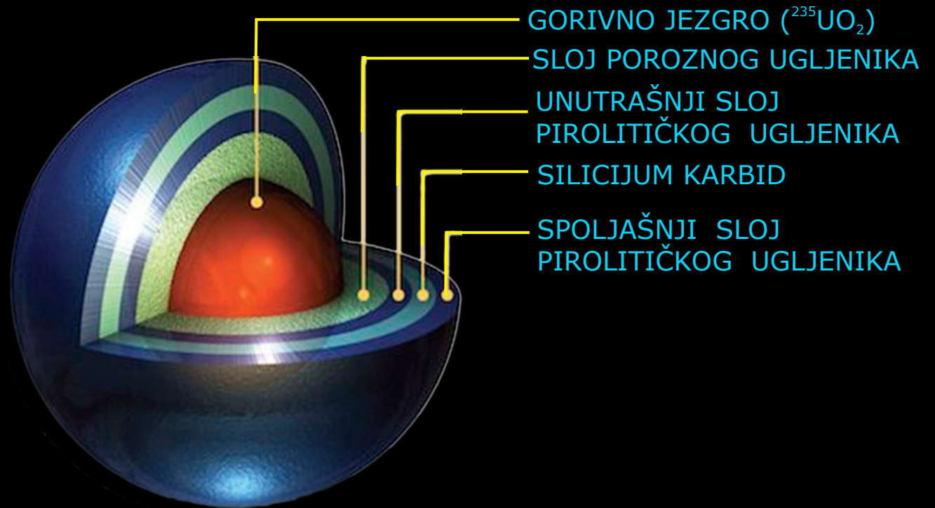
TRISO GORIVNO ZRNO, SHEMATSKI PRIKAZ.
