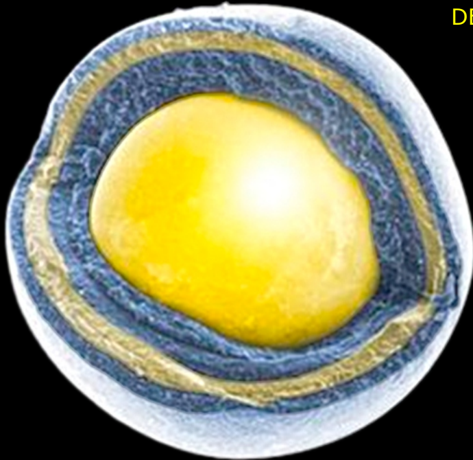
TRISO GORIVNO ZRNO, 0.93 mm. (DIGITALNO OBOJENA FOTOGRAFIJA)
