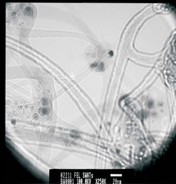
NANOCEVI - FOTOGRAFIJE DOBIJENE ELEKTRONSKIM MIKROSKOPOM (TEM).
