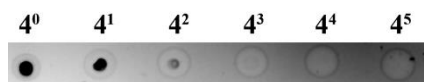
Slika 66. Dot blot fluorescentna detekcija serijskog četverostrukog razblaženja sekundarnih kozjih anti-zečjih antitela obeleženih fikocijanobilinom (eksitacija 532 nm, emisija 580 nm). Nerazblažena antitela ( 4^0 ), antitela razblažena 4 puta ( 4^1 ), 16 puta ( 4^2 ), 64 puta ( 4^3 ), 256 puta ( 4^4 ) i 1024 puta ( 4^5 ).
